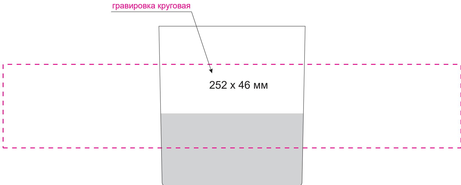
Матовая полоса наносится при производстве изделия на фабрике вручную. Отклонение от положения в этом макете может составлять до 5 мм.
